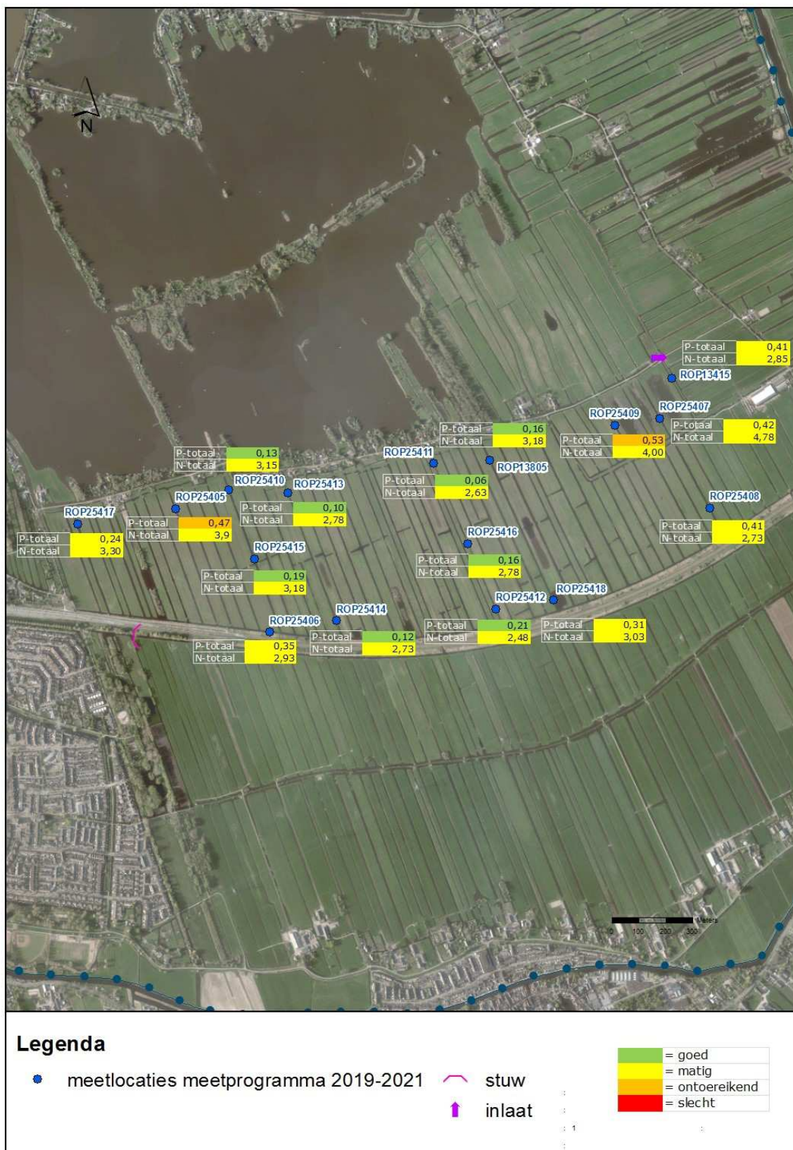
Fig. 8. Meetpunten fysisch-chemische parameters in het meetprogramma 2019-2021 met de meetwaarden in het oppervlaktewater van fosfor (P-totaal) en stikstof (N-totaal) (zomerhalfjaar gemiddelde 2019) in mg/l. De kleurcodering correspondeert met de normering in de KRW (Kaderrichtlijn Water) (Evers et al, 2012).
