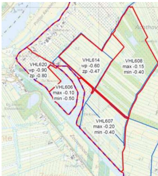
Figuur 3-11. Peilgebieden in en rond het Natura 2000-gebied Zouweboezem (schriftelijke informatie Waterschap Rivierenland, uit provincie Utrecht, 2023)
