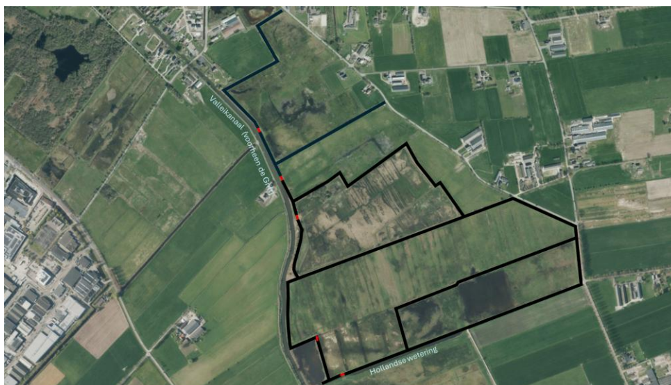
Figuur 3-1. De zwarte lijnen geven de kades en beheerpaden aan die een waterscheiding vormen. De ligging is afgeleid van een AHN verschilkaart (AHN 4 minus AHN 2 ), het AHN 4 en luchtfoto's. In rood zijn stuwen aangegeven die alleen bij zeer hoge waterpeilen in het Valleikanaal en de Hooilandse wetering kunnen worden overschreden.
