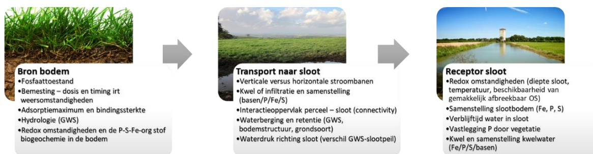
Figuur 3.3 Belangrijkste parameters, uitgesplitst naar bron, transport en sloot, die van invloed zijn op de relatie tussen bodem en waterkwaliteit.
