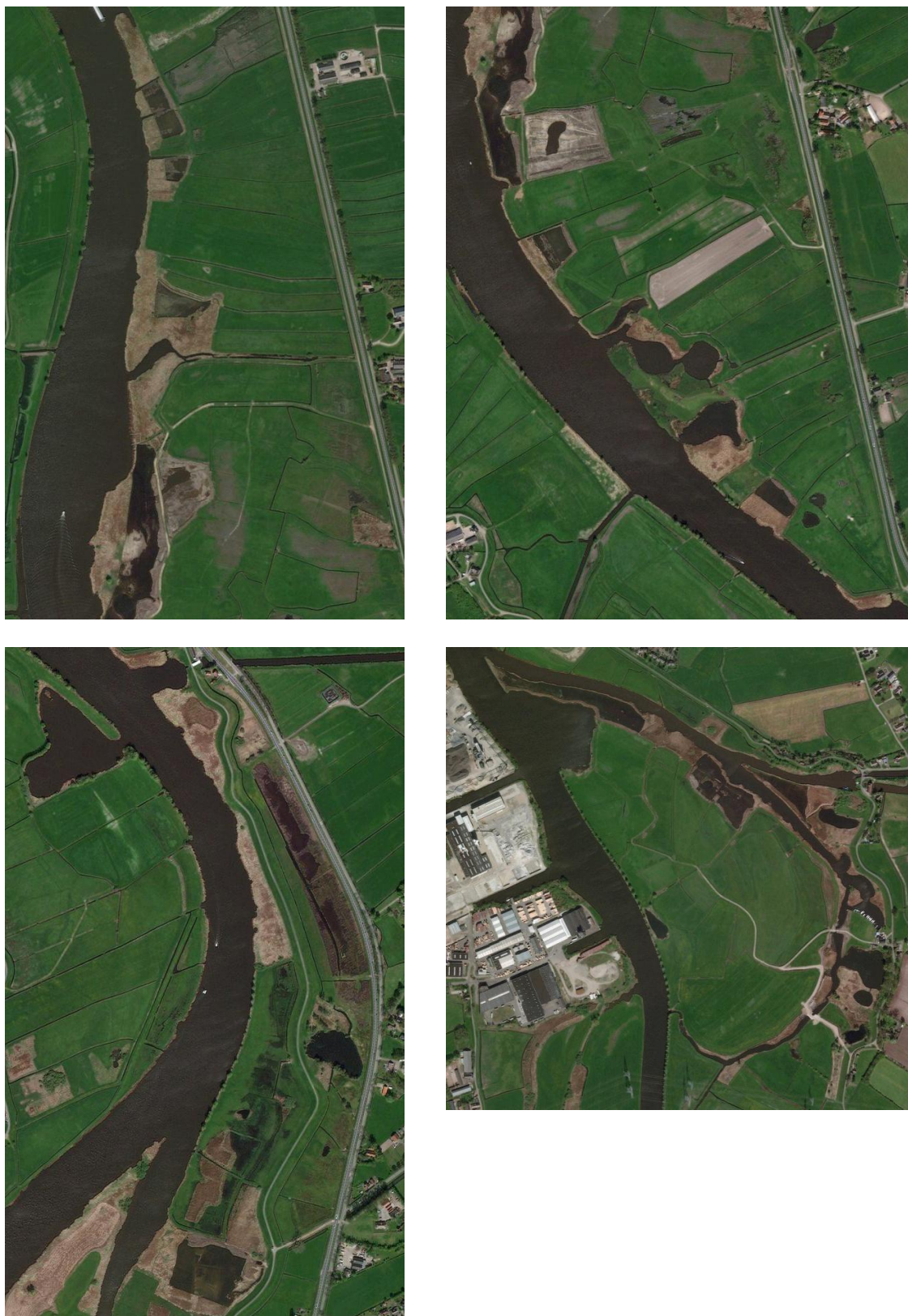
Figuur 3.5. Luchtfoto's van de uiterwaarddelen waar herinrichting is uitgevoerd in 2013 (Bing Maps 2013). Donkere delen in de rietvelden zijn afgeplagd.
