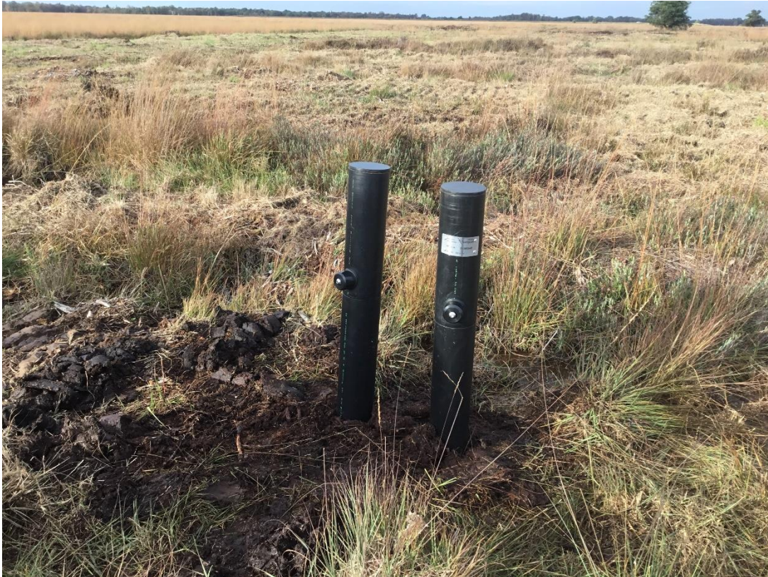
Figuur 3.2 Nieuw geplaatste peilbuizen op locatie ENG68
