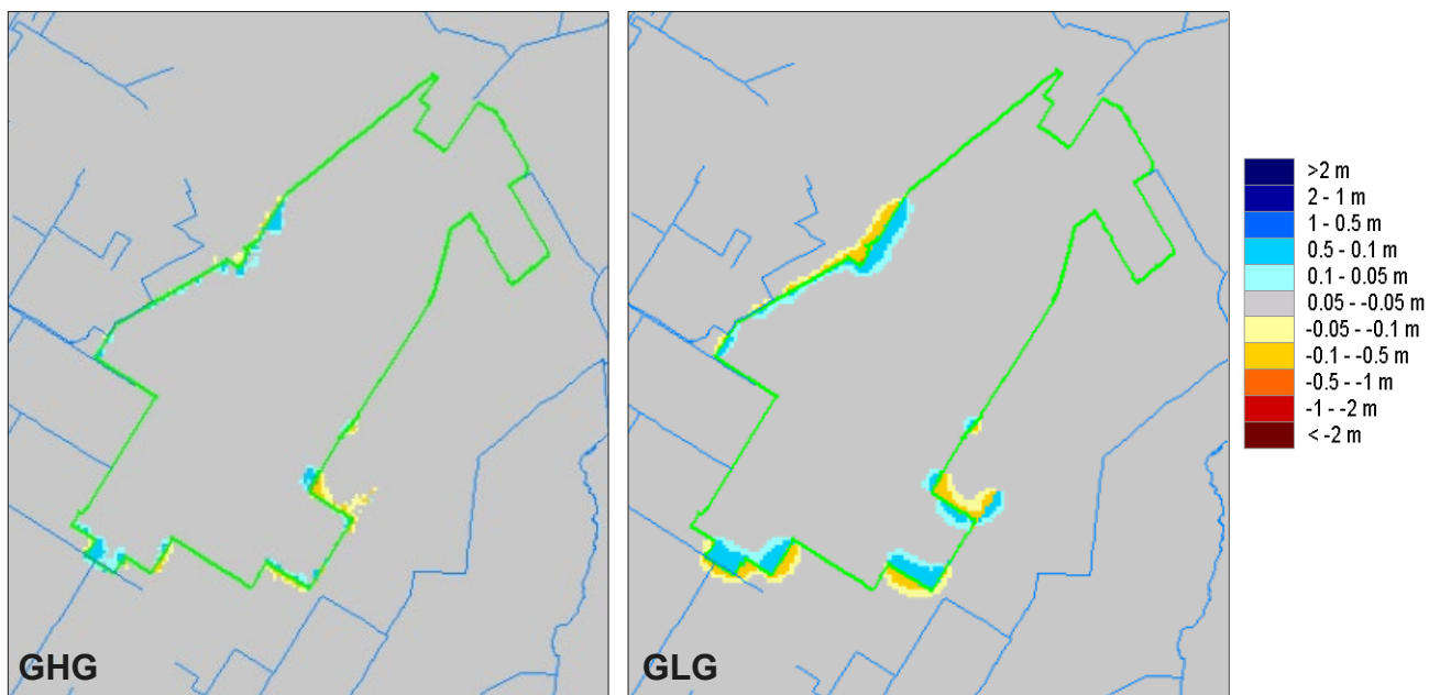
Figuur 21: Effecten kwelscherm op de GHG en GLG in het veen (L3)
