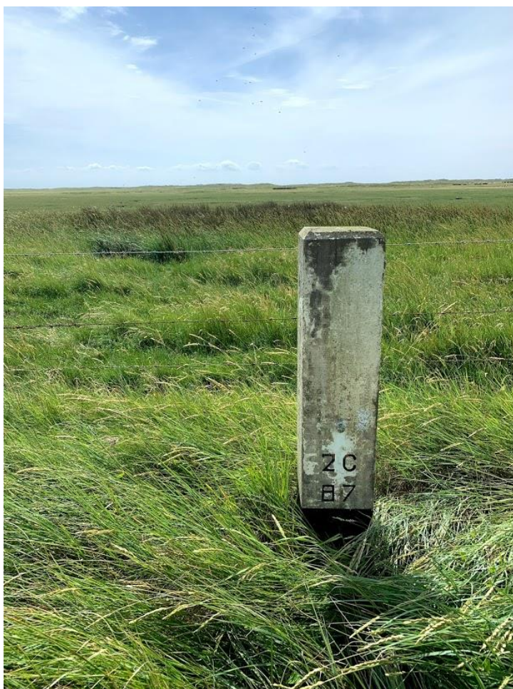
Figuur 2 Peilmerk 02C87 (RD-coördinaten: 187027.38; 608369.95) aan de noordkant van Neerlands Reid, naast het fietspad, dat iedere meetdag werd gebruikt om de meetnauwkeurigheid te bepalen.
